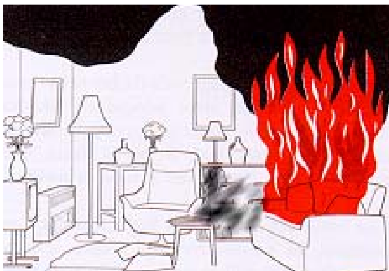
FIGURA 22 - A camada de fumaça atingindo o teto
