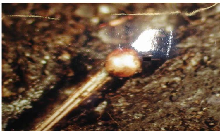
*Figura 5.13 - Fio de cobre sujeito curto circuito terá extremidades brilhantes e arredondadas*
