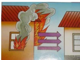
Figura 4.2 – A intensidade da radiação de calor varia inversamente com o quadrado da distância viajada.
