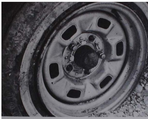
*Figura 5.19 - Os pneus bons podem ser substituídos por pneus piores no local. Porcas não substituídas podem ser a indicação.*
