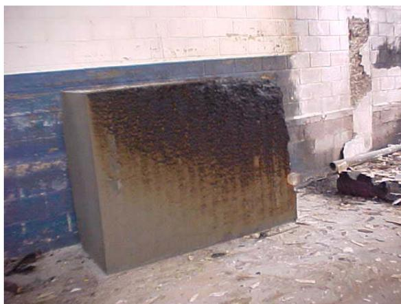
*Figura 5.3 - O lado mais carbonizado de um objeto vertical é o lado no qual o fogo se iniciou*
