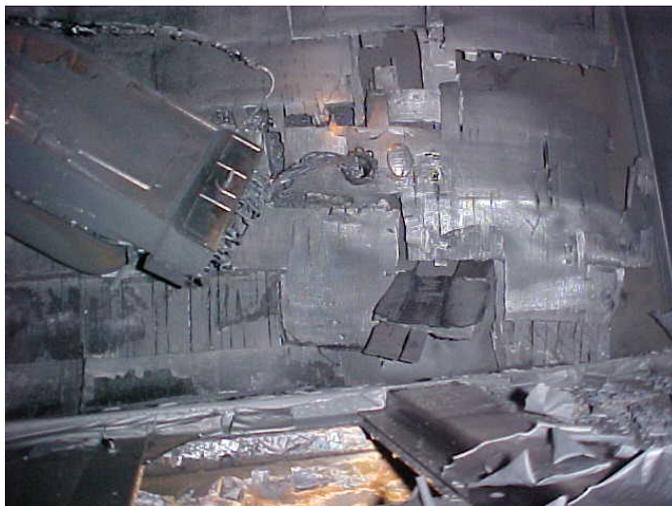
*Figura 6.3 - A cinza normalmente reterá sua forma se não for destruída por bombeiros descuidados.*
