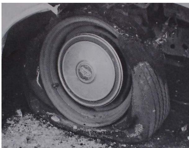
*Figura 5.20 - A parte dos pneus em contato com o solo não será danificada e pode ser comparada com rastros observados no local.*
