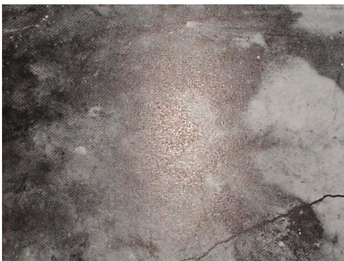
*Figura 6.6 - As manchas grandes de resíduo de hidrocarboneto mostram um cinza preto irregular e determinam o uso de um líquido inflamável neste chão de concreto.*
