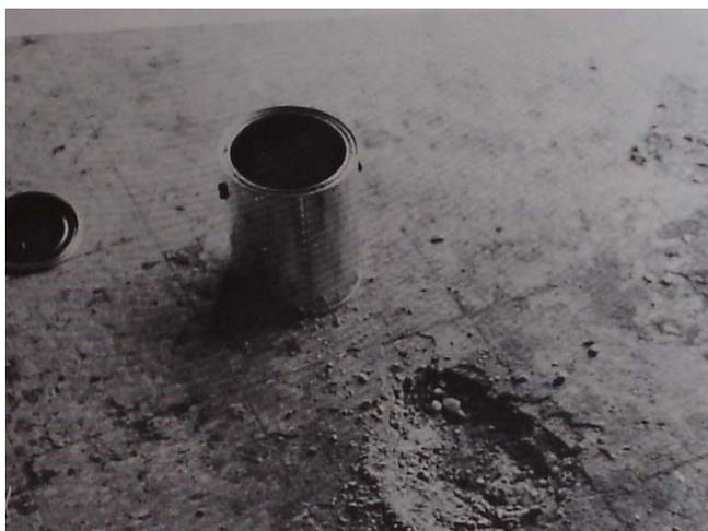
Figura 5.16 - Traço de detonação de dinamite no solo.
