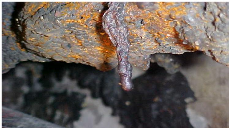
*Figura 5.12 - Fio de cobre sujeito a calor externo poderá apresentar impurezas em suas extremidades.*
