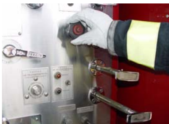
6- Acelerar até atingir a vazão desejada. Para se descobrir a vazão, pode ser usado um medidor de vazão, ou realizar a medição com um aparelho "Pitot". Assim, sabe-se que com 150 PSI, por exemplo, a vazão será de "X". Desta forma, toda a vez que o motorista acelerar até 150 PSI, saberá qual é a vazão.
