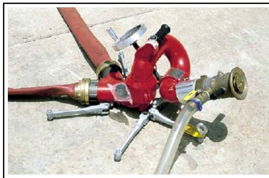
Fig. 21: Esguicho proporcionador de espuma em canhão monitor portátil
