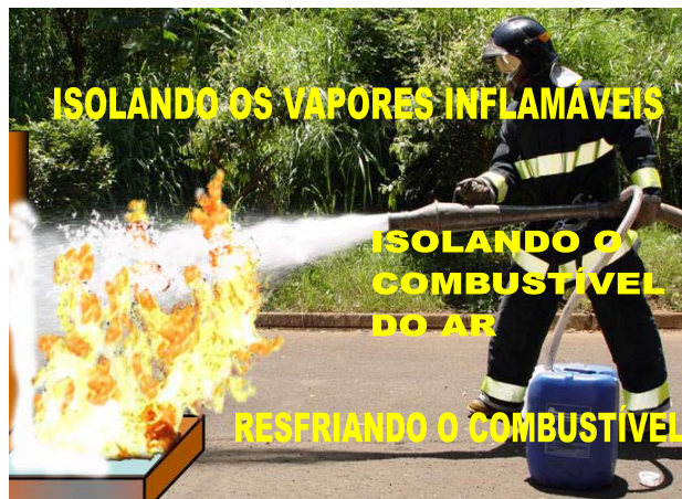
Fig. 1: Atuação de abafamento e resfriamento da espuma.
