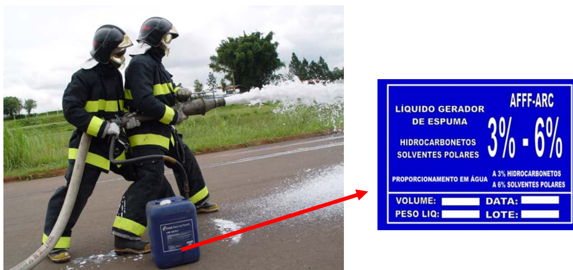
Fig. 5: Linha de espuma com detalhe para o rótulo da bombona de EFE
