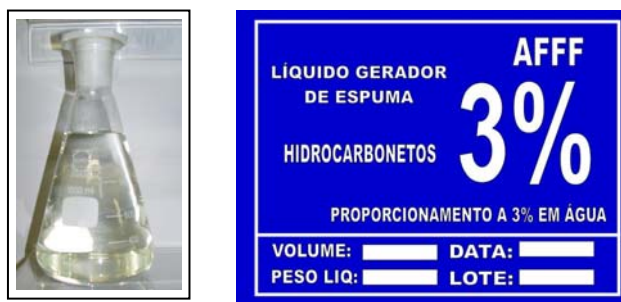
Fig. 6: Detalhe da coloração e modelo do rótulo do AFFF 3%
