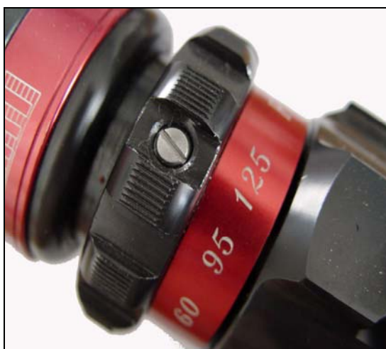
Fig. 20: Detalhe do seletor de vazão Fonte: 16º Grupamento de Bombeiros
