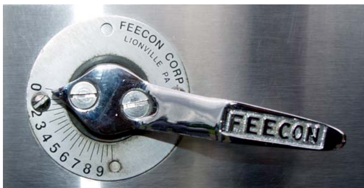
Fig. 22: Dosador do Auto Bomba Plataforma (ABP)
