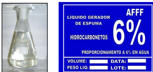
Fig. 7: Detalhe da coloração e modelo de rótulo do AFFF 6%
