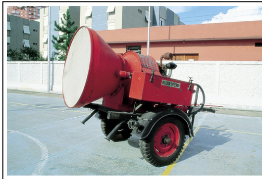
Fig.31: Gerador de espuma de alta expansão
