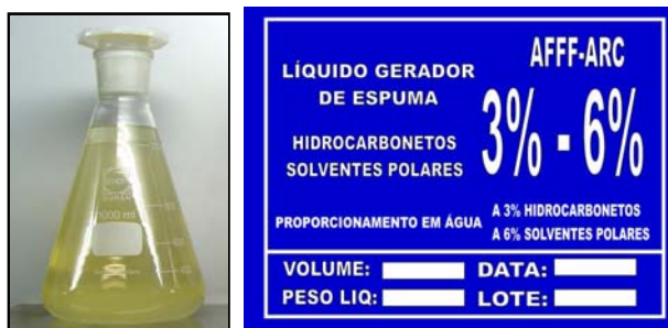
Fig. 9: Detalhe da coloração e modelo de rótulo do AFFF 3% x 6%
