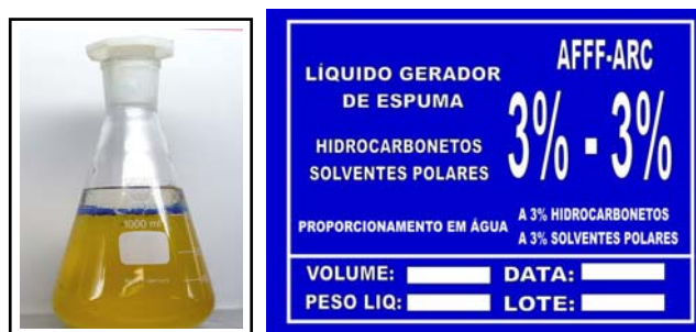
Fig. 8: Detalhe da coloração e modelo de rótulo do AFFF 3% x 3%
