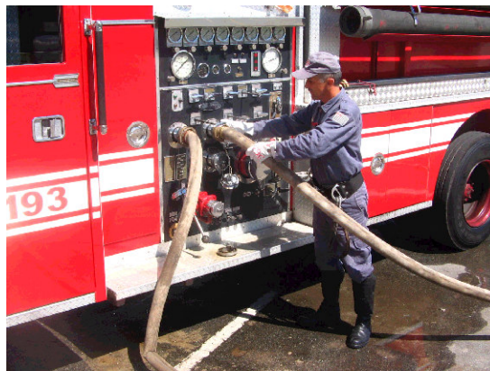
Figura 5.18 - Acoplamento da viatura ao registro de recalque
