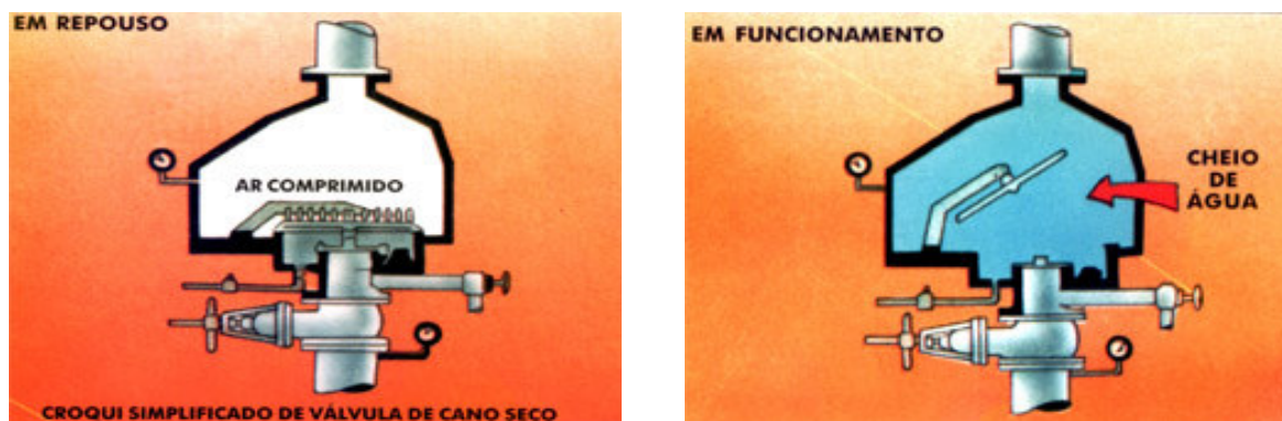
Figura 5.3 - Exemplos de válvulas de governo - cano seco
